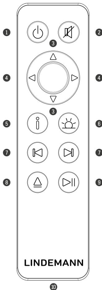
6. **Dimm-Taste:** Steuert die Helligkeit des Displays.
